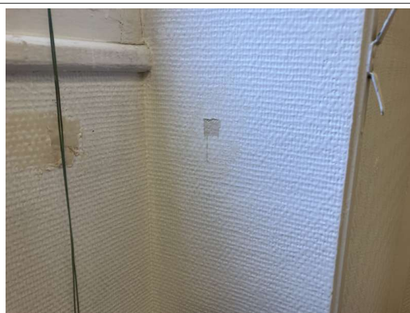
Prélèvement - P19 : Patio 1 / R+1 / Façade Est / Local 140 - Enduit- (Présence d'amiante)
